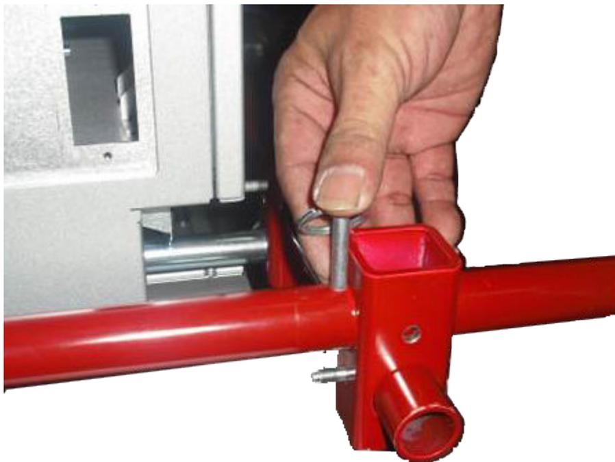
图 6-14 起重套件已安装(X500R 系统)
