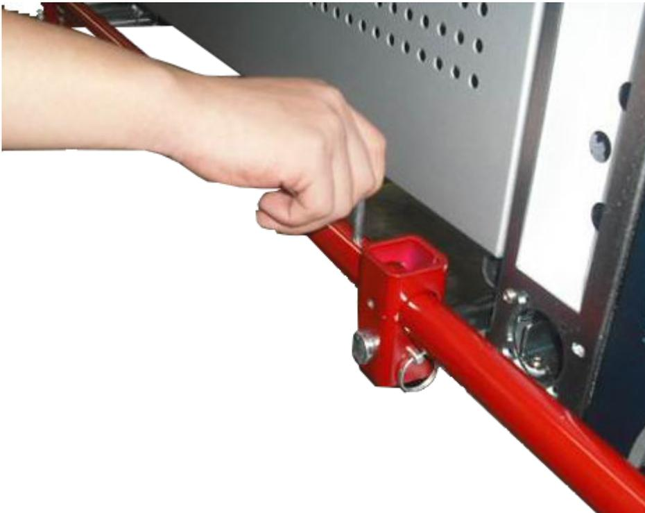
11. 在长棒两端安装高挡块，然后用两个锁定销固定挡块。
