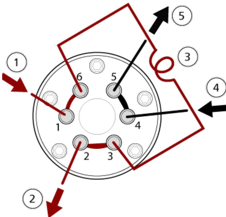
图 3-3 分流阀 - 进样模式 B 位
