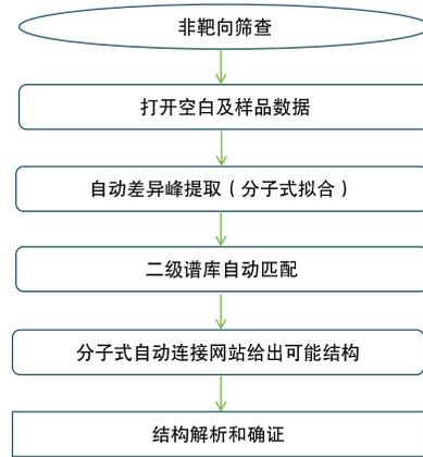
图9. SCIEX Non-Targeted筛查流程
