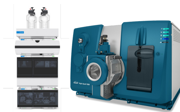
图1. Agilent 1290 Infinity III 高效液相色谱仪串联SCIEX三重四极杆质谱
