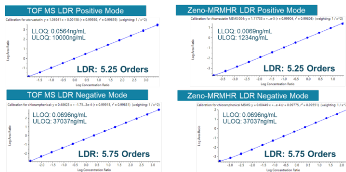
图11. 采用ADC信号处理的4通道MCP检测器的线性动态范围。MS (左) 和MS/MS (右) 采集模式下，可以实现大于5数量级扫描间线性动态范围，同样适用于正离子 (上) 和负离子 (下) 检测模式。
