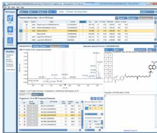
图6. MetabolitePilot™ 2.0 软件结构解析界面，展示MSQC8人肝溶酶体温孵代谢物药物+linker+半胱氨酸结构解析结果，3个碎片m/z 449.2599, m/z 432.2329 及m/z 336.1750均含有丹酰氯基团。
