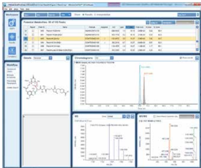
图3. MetabolitePilot™ 2.0软件代谢物鉴定结果界面，图为T-E人肝溶酶体代谢物温孵代谢产物。从图中可以看出，药物加Linker加赖氨酸有1对非对映异构体，提取离子流图保留时间在15.01min与15.27min，药物加Linker的结构显示在左边，结合的氨基酸显示在下边，代谢物对应的一级质谱与二级质谱显示在右边。
