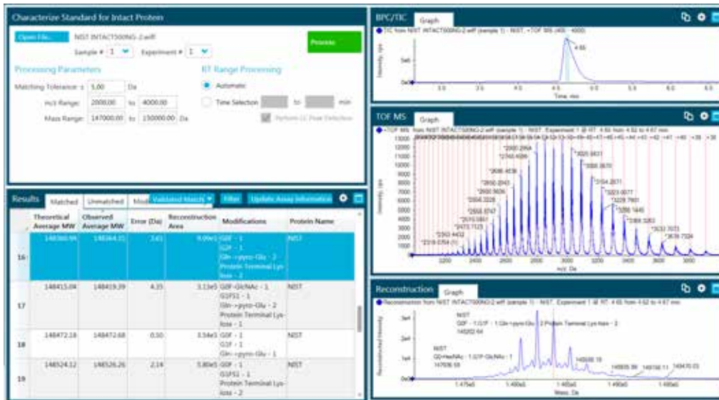
图6. 使用BioPharmaView™软件对未经处理的原始谱图去卷积的分子量测定结果，软件可以全自动的进行样品批处理和可视化对比，节省数据分析时间。
