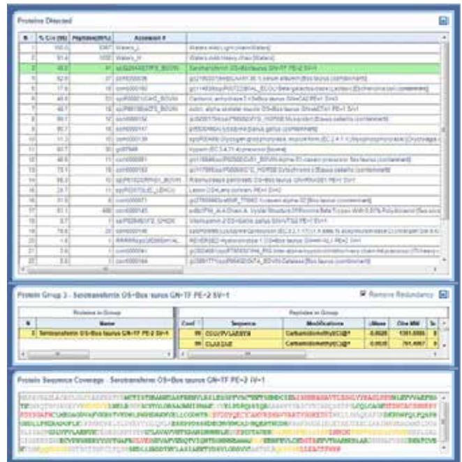
图2. 使用ProteinPilot™鉴定来自CESI-MS的代表性mAb和蛋白质标准品。蛋白质序列中呈绿色的肽代表使用SWATH®值捕获进行定量的最佳候选物，因为它们具有最好的MS/MS信号。将这些肽导入PeakView®/SWATH® microapp进行评估。
