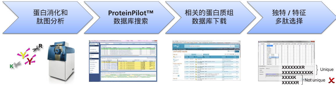
图 1. 使用 SCIEX TripleTOF® 6600 系统和 ProteinPilot™ 软件的特征多肽选择工作流程。
