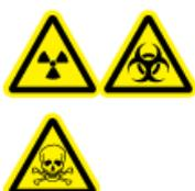
**AVVERTENZA!** Pericolo di contaminazione da radiazioni ionizzanti, rischio biologico o pericolo di esposizione ad agenti chimici tossici. Collegare il sistema di scarico della sorgente a una cappa aspirante dedicata di laboratorio o a un sistema di ventilazione che scarichi verso l'esterno per impedire la diffusione di vapori pericolosi nell'ambiente del laboratorio.
