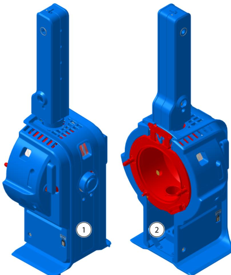
Figura 4-2 Superfici calde della sorgente di ionizzazione OptiFlow Turbo V Nano (Rosso=calde, Blu=maneggiare con cura)
