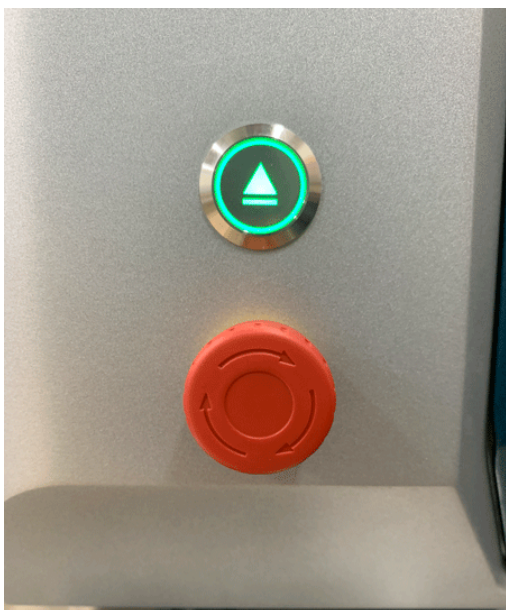
Figure 6-3 Tournez le bouton d'arrêt d'urgence dans le sens des aiguilles d'une montre
