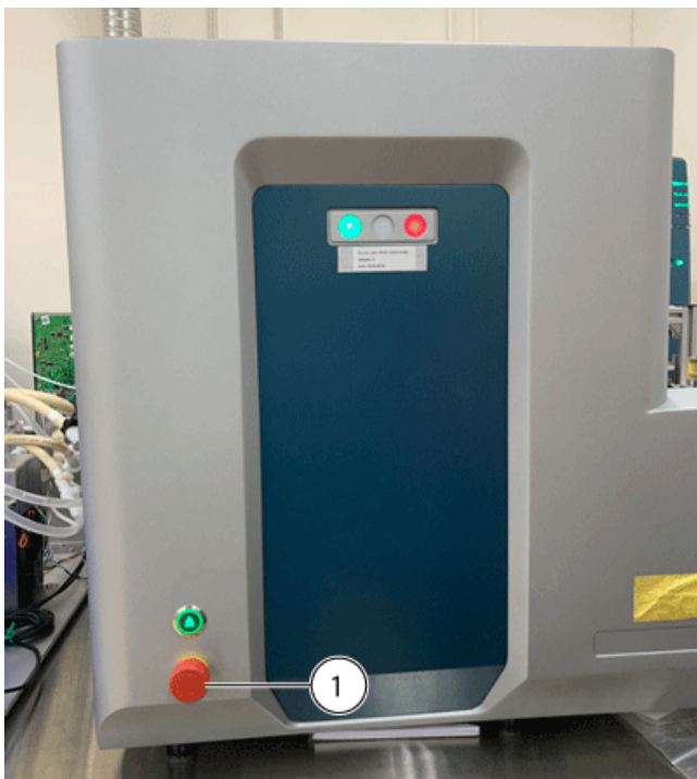
그림 6-1 Echo ® MS Module의 전면 패널에 있는 비상 정지 스위치
