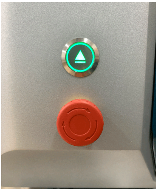
그림 6-3 비상 정지 스위치를 시계 방향으로 돌리기
