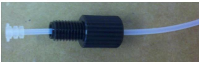
2. Setzen Sie den Schlauch, das Anschlussstück und die Hülse in den Spritzenventil-Anschluss ganz links ein und ziehen Sie dann das Anschlussstück handfest an.
