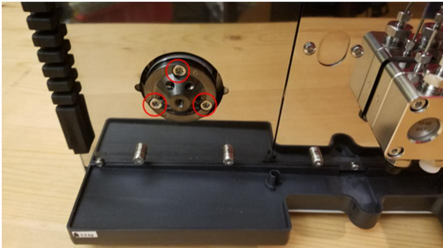
3. Entfernen Sie den Stator vom Ventilkörper.
