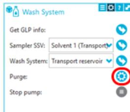
6. Wählen Sie das Lösungsmittel für die Spülung aus und starten Sie dann die Pumpe mit einem mittleren Volumenstrom von 4 ml/min.
