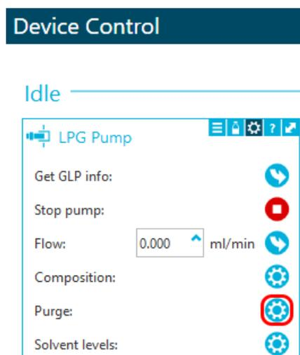
5. Wählen Sie den zu spülenden Kanal aus und starten Sie dann die Pumpe mit einem Volumenstrom von 4 ml/min.
