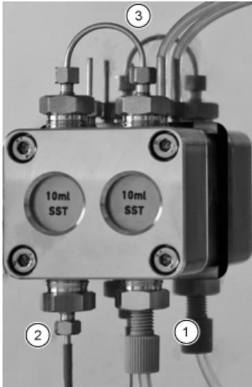
2. Lösen Sie das 1/4-Zoll-Anschlussstück (Element 2) vom Pumpenauslass und entfernen Sie dann die Kapillare.
