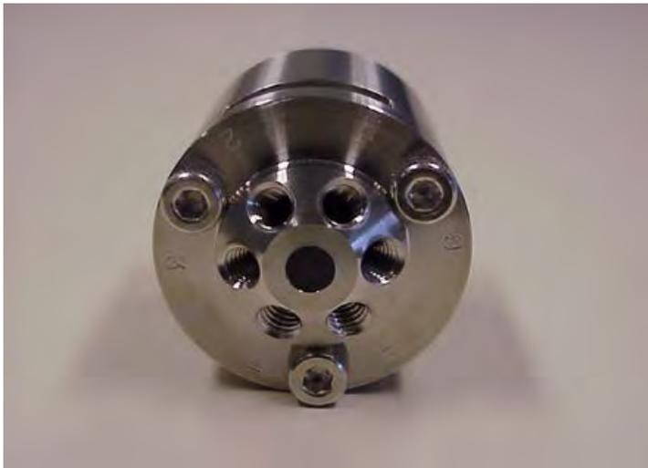
5. Installieren Sie das Injektionsventil mit den Anschlüssen 6 und 1 nach oben zeigend. Fixieren Sie anschließend das Ventil mit den Schrauben, indem Sie die Schrauben abwechselnd um jeweils eine halbe Umdrehung festziehen.
