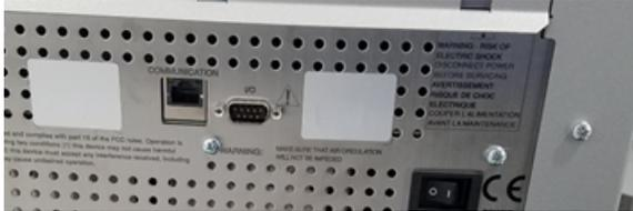
**Abbildung 2-37 AUX-I/O-Port des Massenspektrometers**
