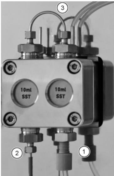
1. Halten Sie den Pumpenkopf mit einer Hand fest und ziehen Sie die vier Torx-Schrauben abwechselnd fest.
