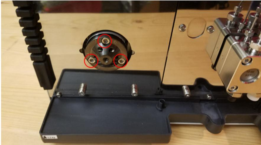
3. Retire el estator del cuerpo de la válvula.
