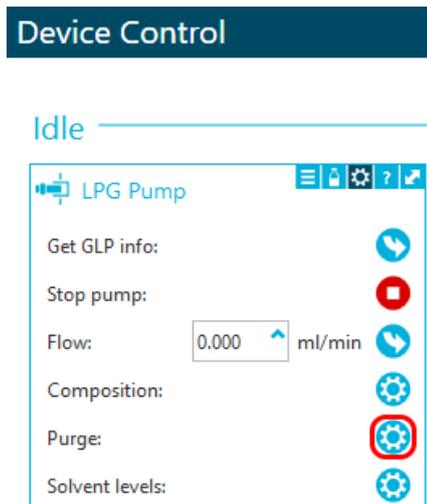
5. Seleccione el canal que desee purgar y arranque la bomba con un caudal de 4 ml/min.
