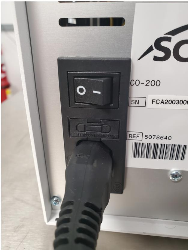
El portafusibles solo puede instalarse en la orientación correcta.
