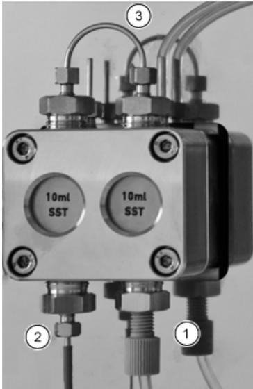
1. Mientras sujeta el cabezal de la bomba con una mano, apriete alternativamente los cuatro tornillos Torx.
