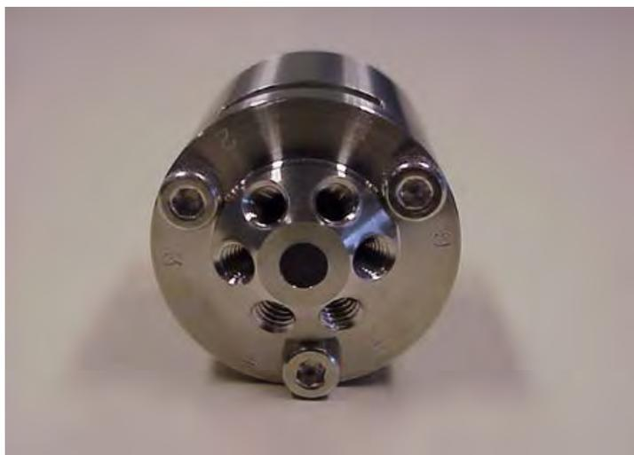
5. Instale la válvula de inyección con los puertos 6 y 1 hacia arriba. Luego fije la válvula con los tornillos, apretándolos media vuelta cada vez, alternativamente, hasta que se hayan apretado completamente.
