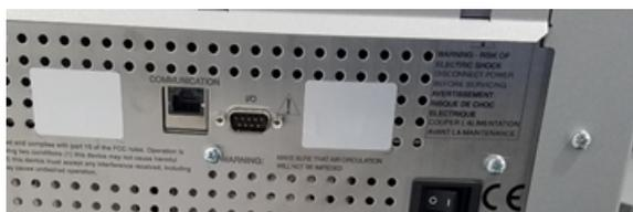
**Figura 2-37** Puerto AUX I/O del espectrómetro de masas
