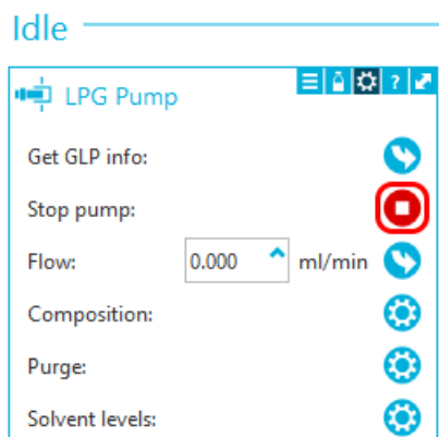
Figure 3-24 Arrêter la pompe
