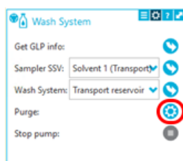
图 3-21 Wash System 部分
