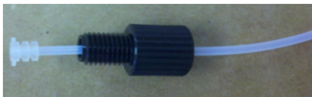
图 3-4 冲洗管路及金属箍
