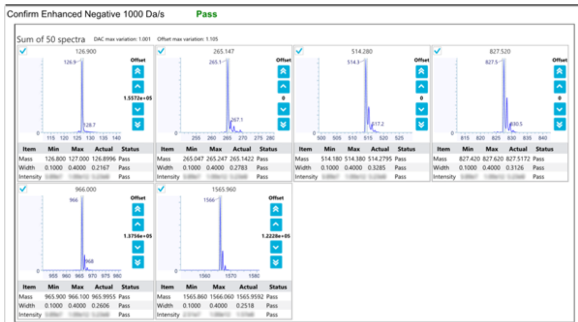
Abbildung 5-19: Beispiel: Negativer LIT-Scan (Modus „High Mass“)
