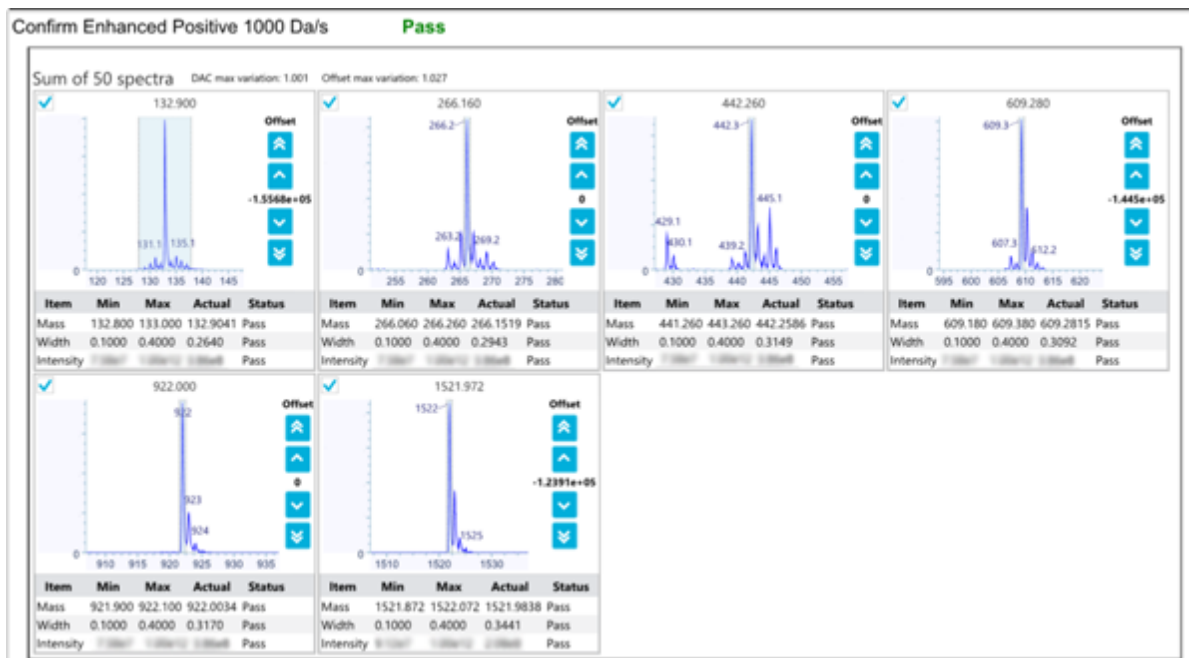
Abbildung 5-18: Beispiel: Positiver LIT-Scan (Modus „High Mass“)
