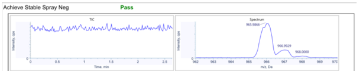
그림 5-15 예: Stable Spray(Negative Polarity, High Mass 모드)
