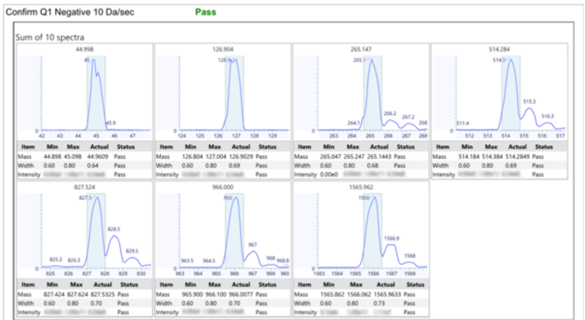
그림 5-17 예: Negative Q1 Scan(High mass 모드)
