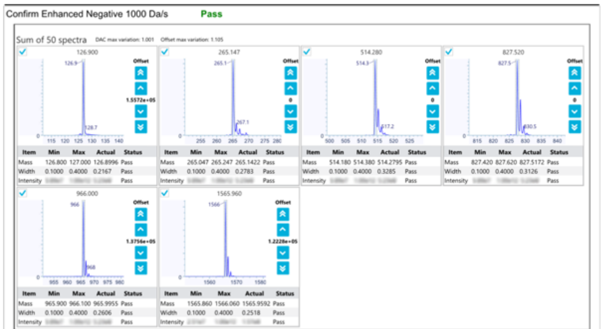
그림 5-19 예: Negative LIT Scan(High Mass 모드)
