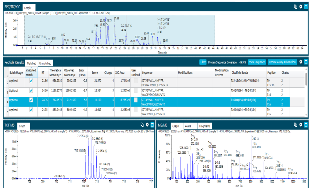
图2. 轻链链内C134-C194二硫键的鉴定结果，第一栏展示的是对应肽段的一级提取离子色谱图，第二栏展示的是C134-C194二硫键通过软件确认的4个电荷态以及二级的得分，第三栏展示的是对应二硫键肽段的一级和二级质谱图。
