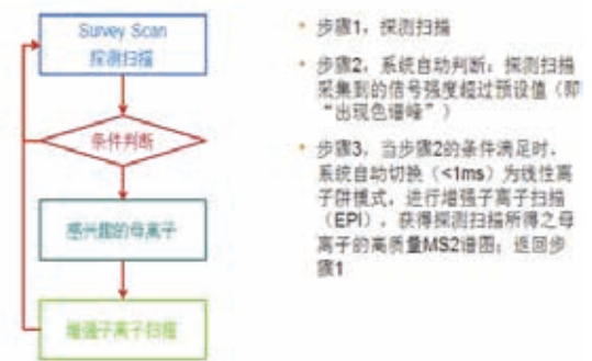
图1b. Qtrap: MRM触发IDA工作原理。
